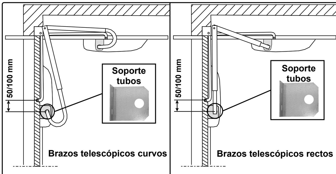
Posicionar el motor M sobre el larguero de modo que los piñones estén perfectamente en línea con los tubos y fijarlo.
