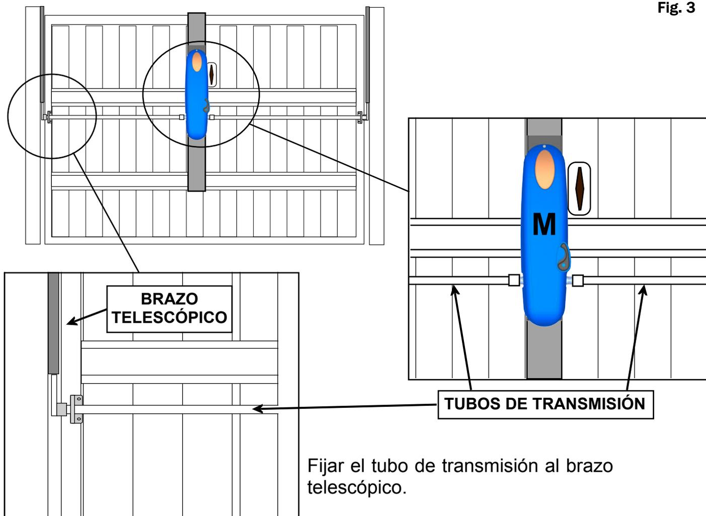
Fijar el tubo de transmisión al brazo telescópico.
