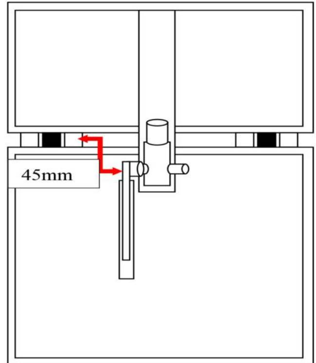
LOS CUADROS SALEN INSTALADOS PARA PUERTAS QUE ABREN HACIA DENTRO ( APERTURA INTERIOR). SI LA PUERTA ES DE APERTURA EXTERIOR SE DEVEN CAMBIAR LOS GIROS Y LOS FINALES DE CARRERA.
