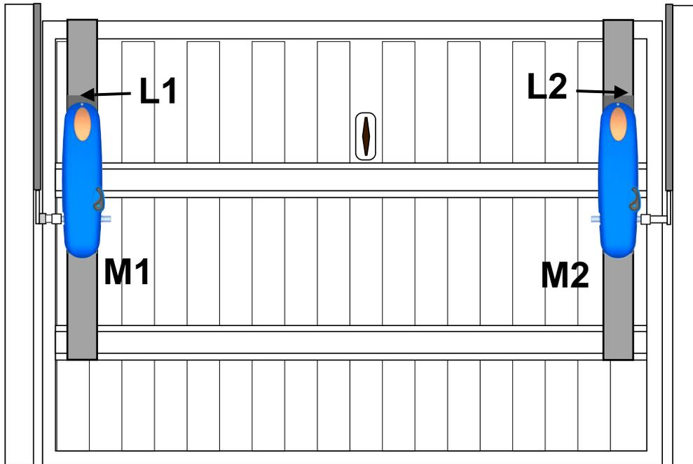
Fijar los motores en los largueros de manera que sean en línea con los alojamientos de los brazos, a una distancia entre **50 y 100 mm** a bajo, poner como referencia el perno del brazo existente.
