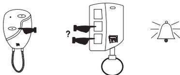
Al instante que hagamos presionado el canal deseado la centralita sale de programación y se apaga el led, El canal deseado es para todos los emisores por igual.
