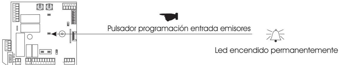
Volver a presionar el *pulsador de programación de emisores* por segunda vez antes de 10 segundos la central emite otro bib y el led cambia de estar encendido permanentemente a intermitente. Seguidamente antes de 10 segundos presionamos el canal del emisor que deseamos que haga esta función indicando su correcta codificación emitiendo un bib.
