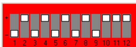
Trama de impulsos de un mando binario y posición correspondiente en los switches.
