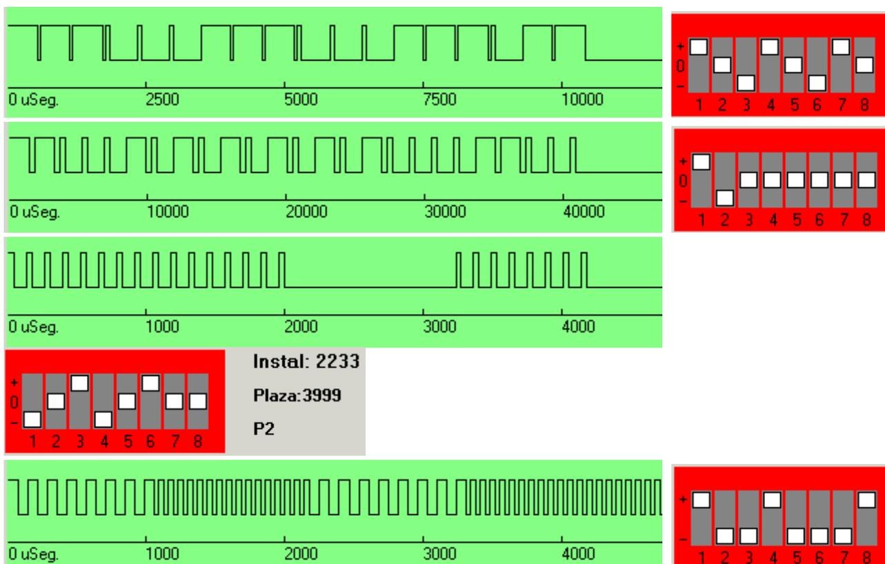
Ejemplo de parte de la trama y de la posición de los switches de un mando E20.
