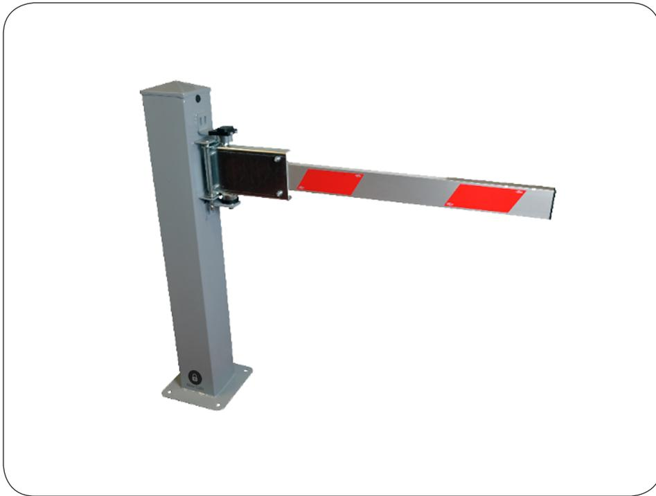
Barrera manual (nuevo diseño) con llave para accionamiento manual rotativo. Asta de 4 a 6 metros. Estructura de acero tubular y electro-galvanizado. Asta de 80x30x2mm con bandas reflectantes rojas.
