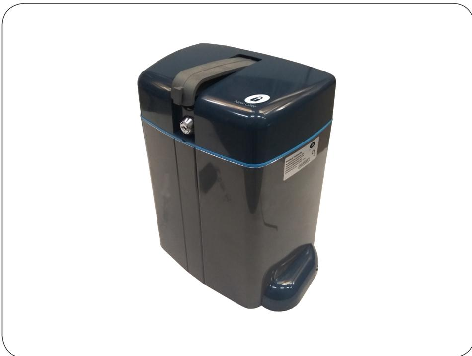
Motor 24V con central incorporada y receptor. Su conjunto de engranaje móvil absorbe el desnivel del suelo hasta 35mm. Sin necesidad de conectar finales de carrera, rigiéndose por el paro mecánico trasero.
